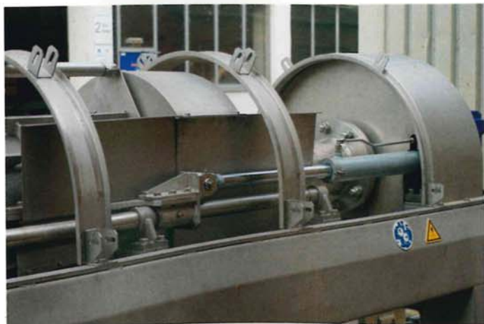
Abb. 5: Verstellung der Siebkorbposition
