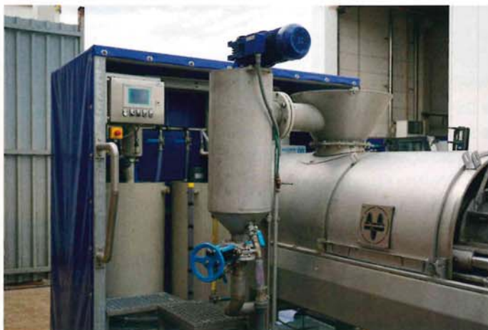
Abb. 3: Akupress LX mit Flockungsreaktor
