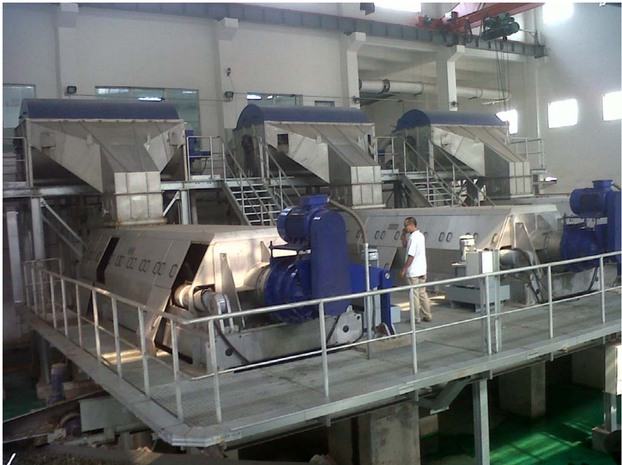
Entwässerungssystem mit 3 Linien
