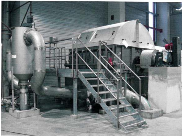
Abb. 5 links: Flockungsreaktor FR; rechts: Scheibeneindicker AKSE S 300/05
